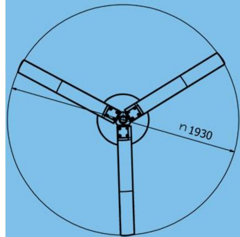
La turbina DS700 es una **micro turbina eólica híbrida de eje vertical** de 1kW, utilizada en combinación con energía fotovoltaica para sistemas residenciales y comerciales de tamaño pequeño / mediano.
