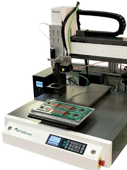
Robot di dosatura a 3/4/5 assi dotati di sistemi e valvole per dosatura a contatto o senza contatto. Ampia gamma di accessori: valvole - serbatoi di materiale - siringhe - punte - ugelli.
