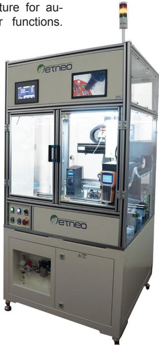
Etneo realizza celle di assemblaggio con convogliatore integrato nella struttura per linee di produzione automatiche per saldatura dall'alto, dispensazione e altre funzioni.
